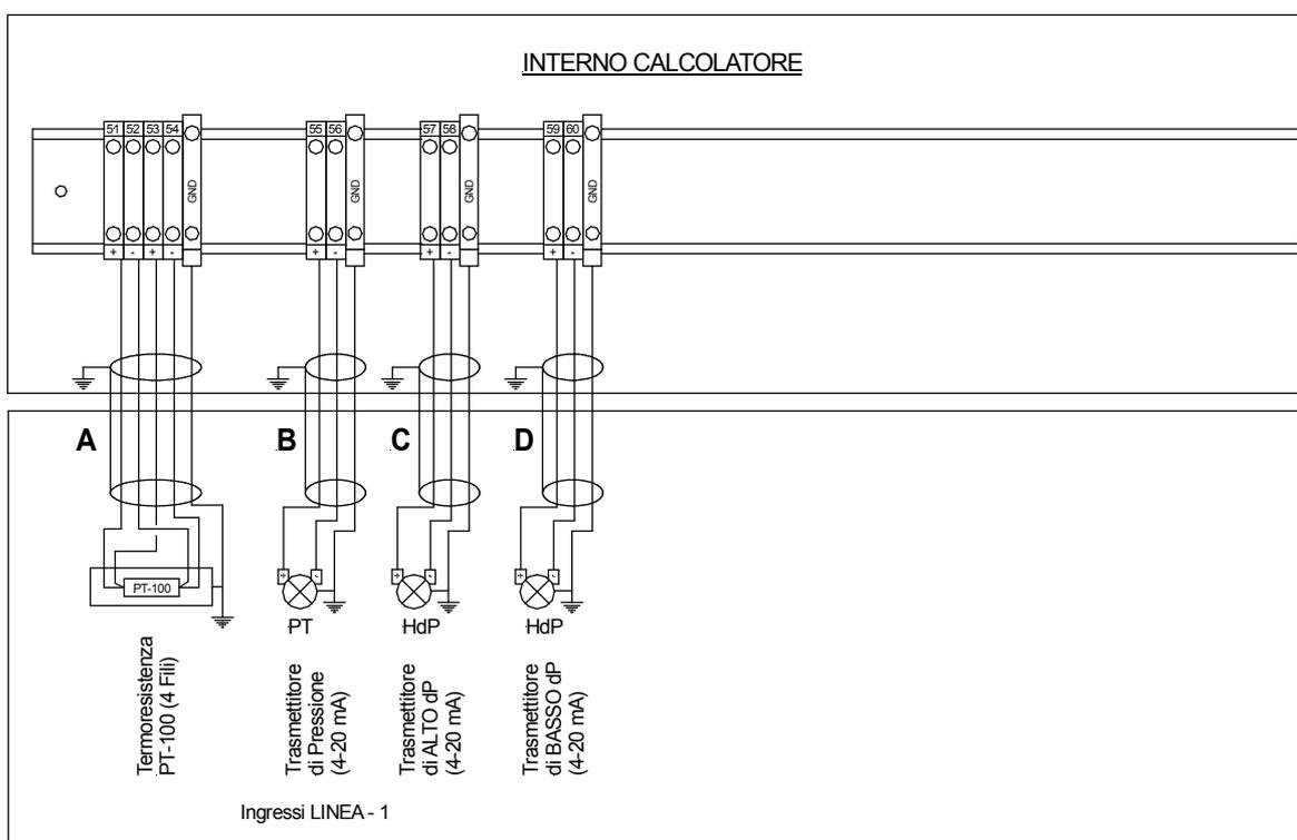
Per il collegamento dei trasduttori al calcolatore occorre utilizzare cavi antifiamma CEI-20-22 aventi le seguenti caratteristiche:
